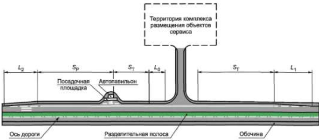
Примечание — Размеры L_0 , L_1 , S_Г , S_Р и L_2 определяют в соответствии с ГОСТ 33100, ГОСТ 33149.
